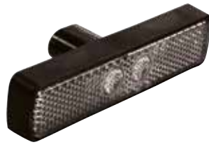
Cadre standard - avec prise de courant Super Seal
